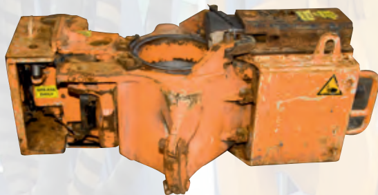
Центральнозамковый элеватор типа ACL для труб с седлом под конус 18°
