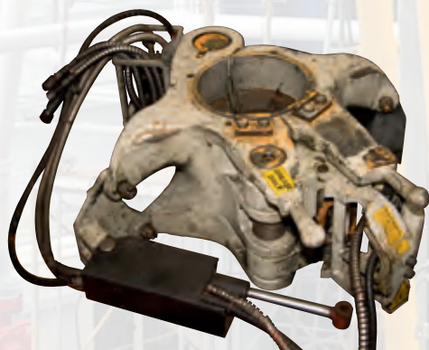
Центральнозамковый гидравлический элеватор типа CL для труб с седлом под конус 18°
