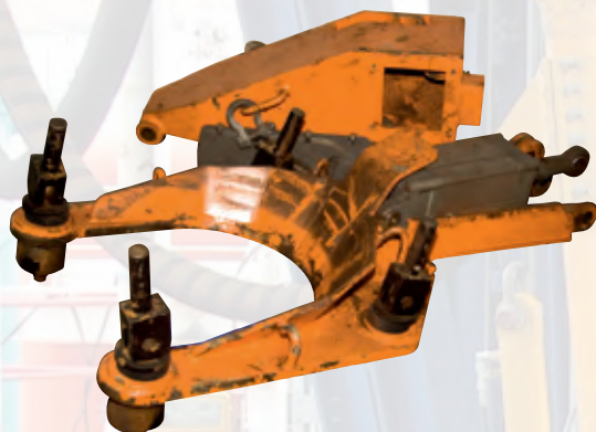
Центральнозамковый гидравлический элеватор типа CL для труб с седлом под конус 18°
