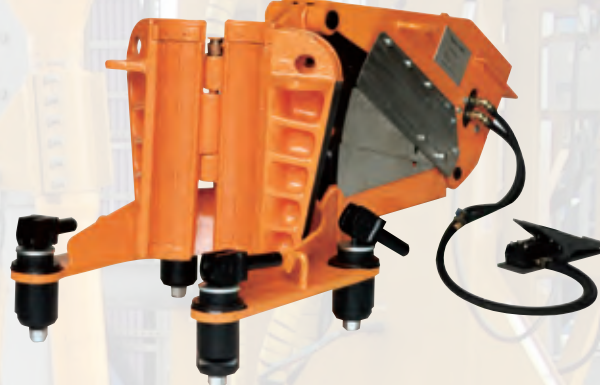
Центральнозамковый гидравлический элеватор типа CL для труб с седлом под конус 18°
