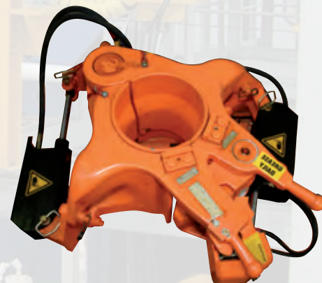
Центральнозамковый гидравлический элеватор типа CL для труб с седлом под конус 18°
