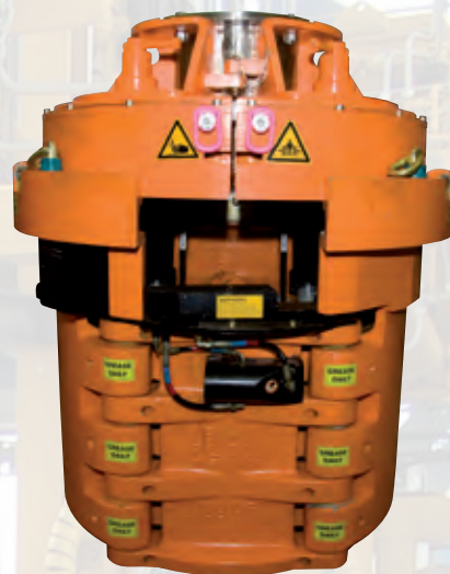
Клиновой захват PS 500 с верхней направляющей втулкой для компенсации износа
